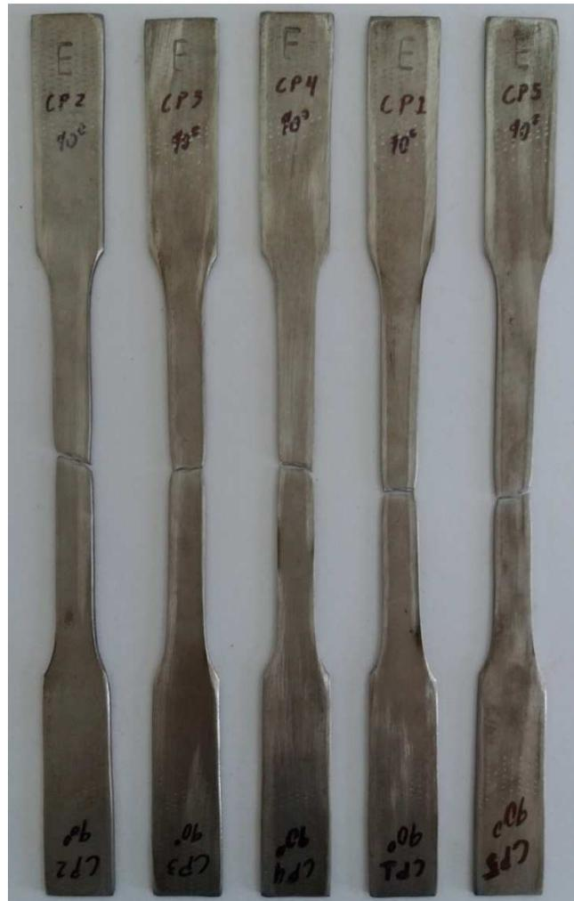
No gráfico apresentado na Figura 46, têm-se os valores médios para o limite de escoamento e para o limite de resistência à tração, por sentido de laminação. Fez-se a média dos resultados obtidos de cada CP por sentido de laminação, portanto, a média é composta por cinco valores em cada variável analisada.
