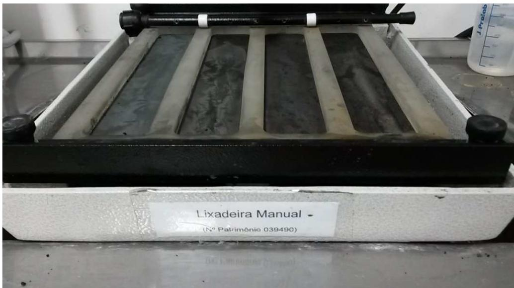
Figura 28 - Representação esquemática do método de lixamento com trabalho em sentidos alternados
