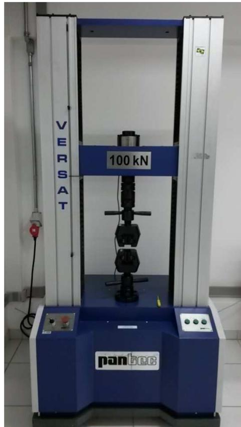
Primeiramente foram ensaiados os cinco corpos de prova extraídos no mesmo sentido de laminação da chapa. Inicia-se o ensaio inserindo os parâmetros pré-estabelecidos para o
