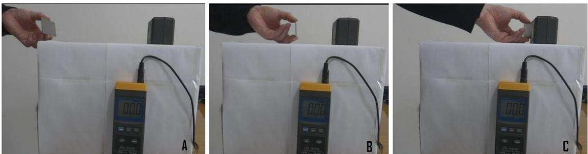
Ao aproximar o corpo de prova do sensor, o display do medidor inicia a indicação do valor do campo magnético, sendo adotado como medição final o valor indicado ao tocar o CP no sensor. Esse procedimento foi repetido três vezes para cada CP, a fim de identificar os
