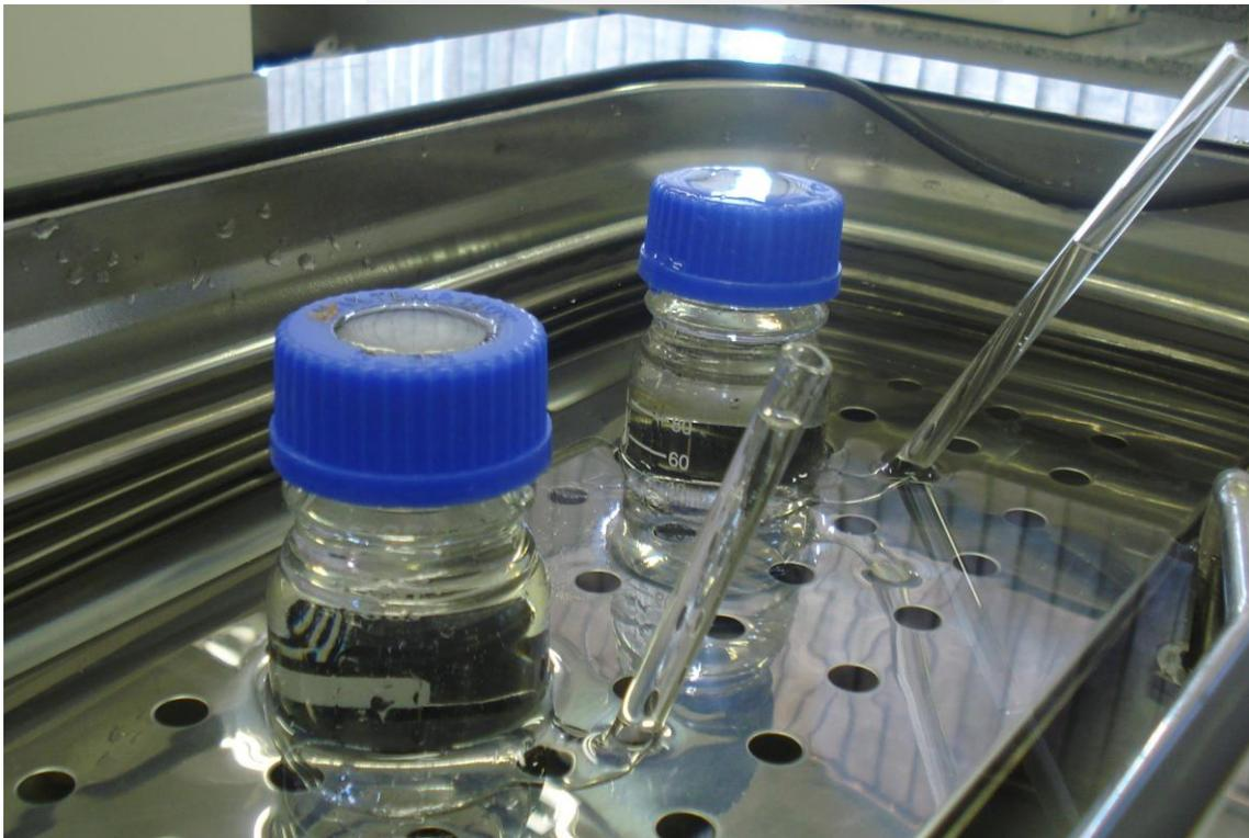
Figura 9: Sistema de difusão vertical, sobre a mesa de banho ultratermostatizada a 37°C, utilizados na pesquisa
