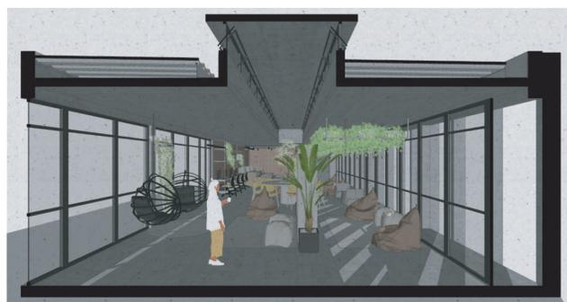
Corte: lanternim para iluminação e ventilação natural. A ideia é gerar o efeito chaminé, para auxiliar no conforto térmico do ambiente.
